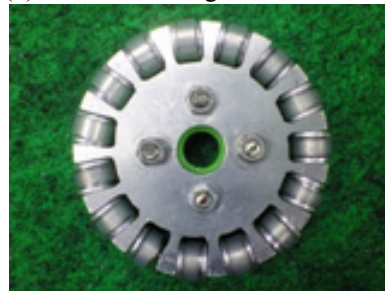
(d) with thick silicone rubber ring tires
